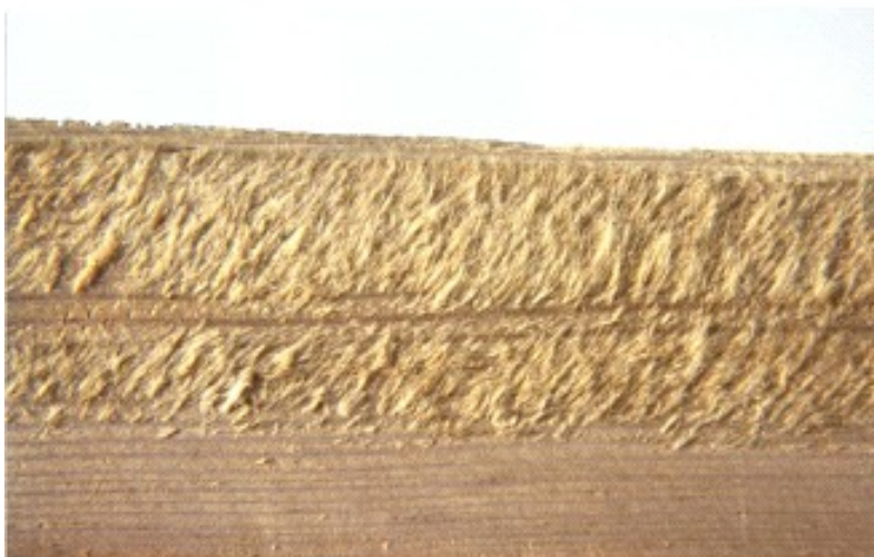
Rys 12: Włókna postawione po wyługowaniu
